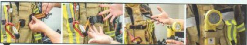
Gurt herausziehen; Lasche am Gurt fixieren; rechtes Gurtende ziehen und Cobraschloss schließen.
